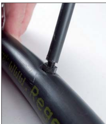
Das Steigrohr wird auf den Adapter geschraubt
