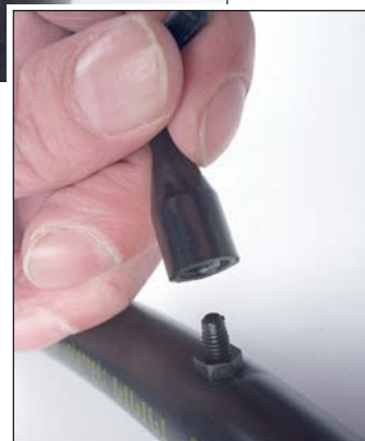
Ein Adapter für eine Steigleitung wird mit dem Schlüssel in das Loch geschraubt
