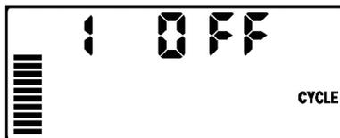
2. Sobald die gewünschte Station angezeigt wird, können Sie mit den Tasten **+** oder **-** die Zykluszeit verringern oder erhöhen. Sie können die Sickerzeit von 1 Minute bis 4 Stunden in 1-Minutenschritten einstellen oder auf **AUS**, wenn kein Zyklus angewendet werden soll.
