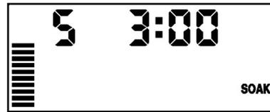
Bildschirm Sickerphasen mit angezeigten Stunden
