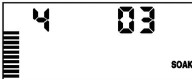
Bildschirm Sickerphasen mit angezeigten Minuten
