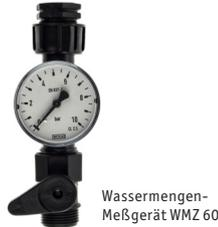
Bei vorhandener Wassermenge ab Start unter 1300 l/h (Füllzeit länger als 27 Sekunden) und einem Fließdruck von 2 bar ist die Planung einer Rasenbewässerung sehr aufwendig und nur schwer möglich. Bei einer Topf-, Beet- oder Heckenbewässerung sollte die vorhandene Wassermenge 800 l/h (Füllzeit kürzer als 45 Sekunden) bei einem Fließdruck von mind. 1,5 bar betragen.
